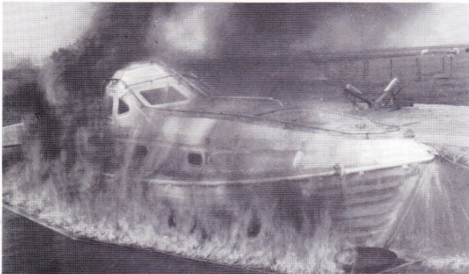
Brandproef met een zg. 'free-fall' aluminium reddingboot
